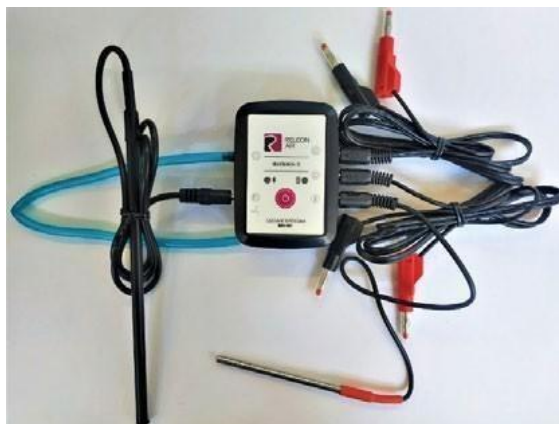
Рис. 9. Беспроводной мультиметр Releon Air «Физика-5»
